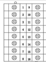
WT-A600系列48×96（竖式）后端子图（横式将上图逆时针旋转90度）
